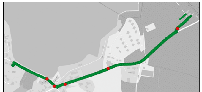
Abbildung 4: Latenztests entlang der kompletten Teststrecke in Roding. In Grün: Messpunkte mit sehr geringer Latenz.
