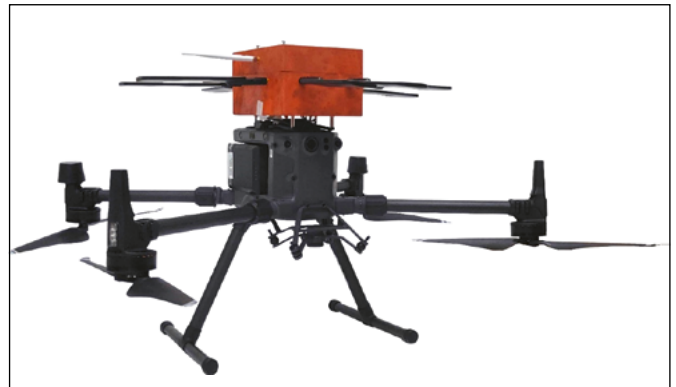
Abbildung 1: In-Flight-QoS-Messsystem, montiert auf eine handelsübliche Drohne.
