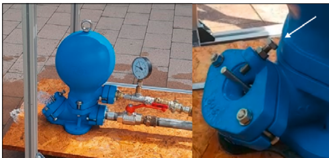
Abbildung 6: Der Falke-Widder aus [8], das Stoßventil mit Einstellschraube.
