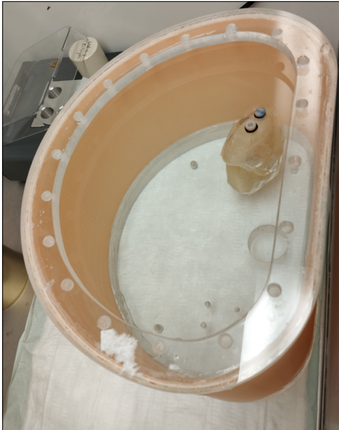
Abbildung 2: Im Bodyphantom eingesetztes Nierenphantom, das mit TLDs bestückt ist.
