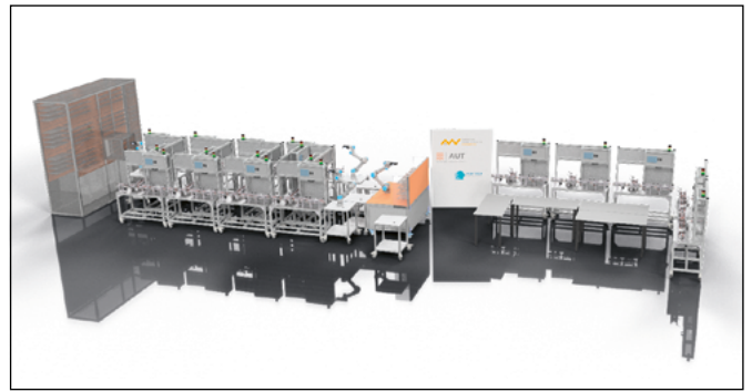
Abbildung 8: Mit digitalem Zwilling geplantes und simuliertes Anlagenlayout.
