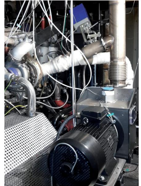
**Bild 3** Turbinen-Generator-Einheit
