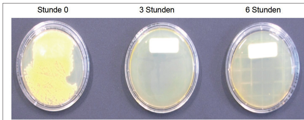
Bild 5: Untersuchung der antimikrobiellen Wirksamkeit einer TPU-Oberfläche mit der Abklatschmethode und Keimzahlbestimmung in 3-stündlichen Abständen
