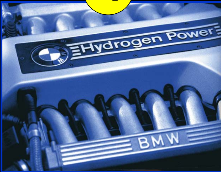
BMW 750hL: 5,4 l-V12-Motor, 150 kW, 300 km mit 140 l H 2 (-273°C)
